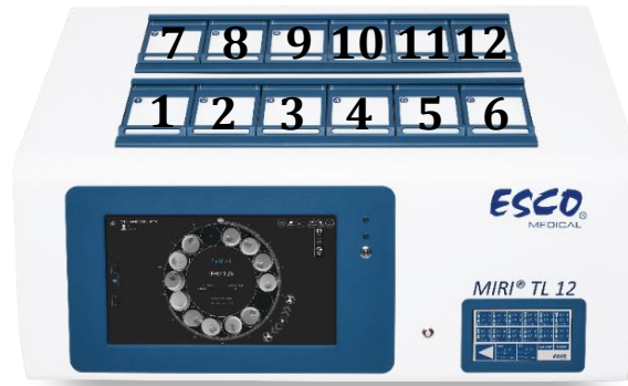
Figura 7.2 Numerazione delle camere sull'incubatore multicamera IVF MIRI® TL12
