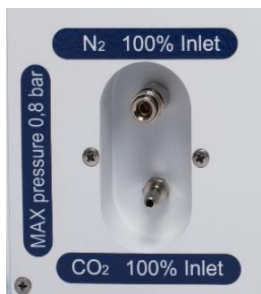
Figura 11.1 Ingressi per il gas
