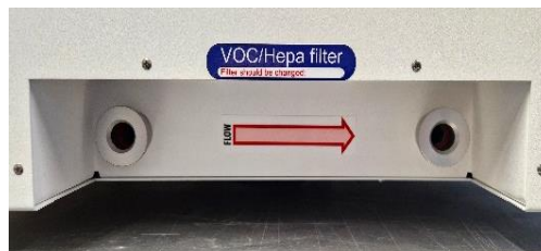
Figura 12.1 La freccia di flusso sugli incubatori multicamera IVF MIRI® TL6 e MIRI® TL12
