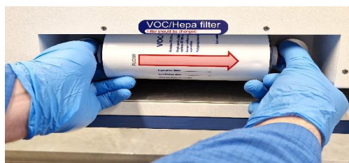
Figura 12.2 Procedura di inserimento e rimozione del filtro VOC/HEPA
